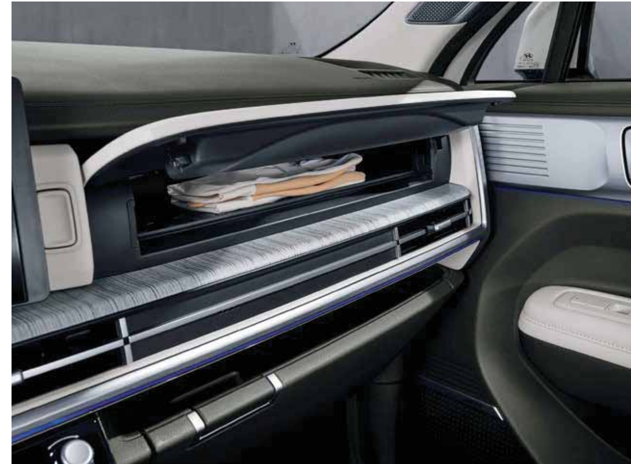
UV-C sterilisatielade; bovenop het handschoenenkastje zorgt deze voor gemakkelijke sterilisatie van veelgebruikte items, zoals mobiele telefoons en portefeuilles.
