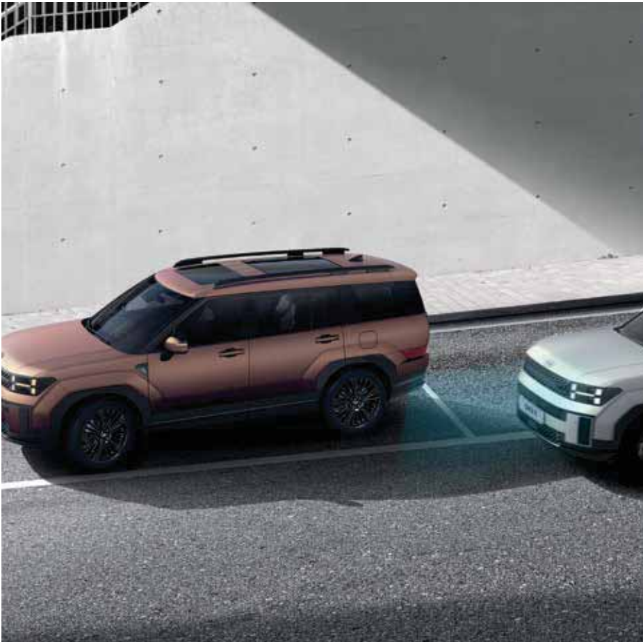
Blind-Spot Collision-Avoidance Assist (BCA) waarschuwt u als er een kans is op een aanrijding met een achteropkomend voertuig in de dode hoek tijdens het wisselen van rijstrook. Bij het voorwaarts verlaten van een parallelparkeervak, als er een risico is op een aanrijding met een voertuig dat van achteren nadert, assisteert het automatisch bij het maken van een noodstop.
